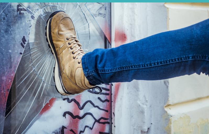
Le film **PROTECGRAFF 120** protège le vitrage des tags et gravage sur verre. Il renforce le vitrage et empêche le verre d'éclater en cas de choc ou d'incendie, tout en conservant une parfaite transparence. Il réduit l'adhésion des tags et facilite leur nettoyage. Il protège le verre en absorbant le gravage. Il s'applique sur le verre, le polycarbonate, l'inox.
